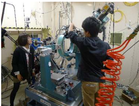
図1. KEK PF BL-4C の四軸回折計。
