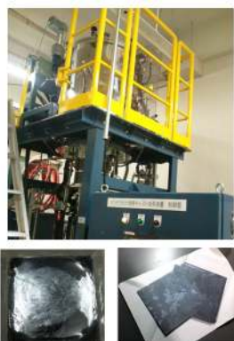
キャスト成長装置と Si 多結晶インゴット
